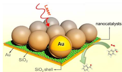
图 1. 用于纳米催化反应原位研究的 SHINERS-gap 结构示意图
